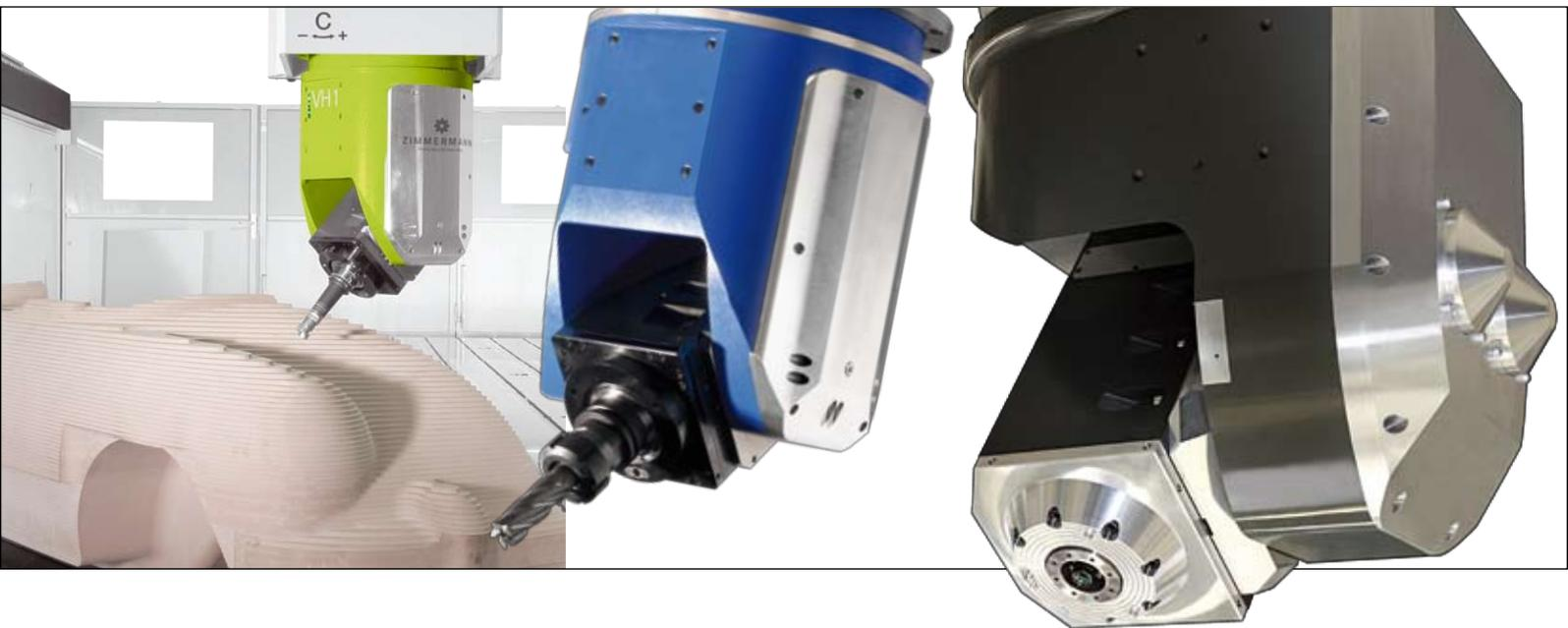
**VIPAtec X24:** die hohe Dynamik verbunden mit einer großen spezifischen Leistungsdichte. Durch sein geringes Gewicht können maximale Achsbeschleunigungen realisiert werden und der kleine Störkreis ermöglicht präzise Bearbeitungen in kleinstem Arbeitsraum. Die spielfreien Verspanngetriebe in A- und C-Achse ermöglichen das exakte Positionieren der Bearbeitungsspindel bei gleichzeitig hohen Steifigkeitswerten.
